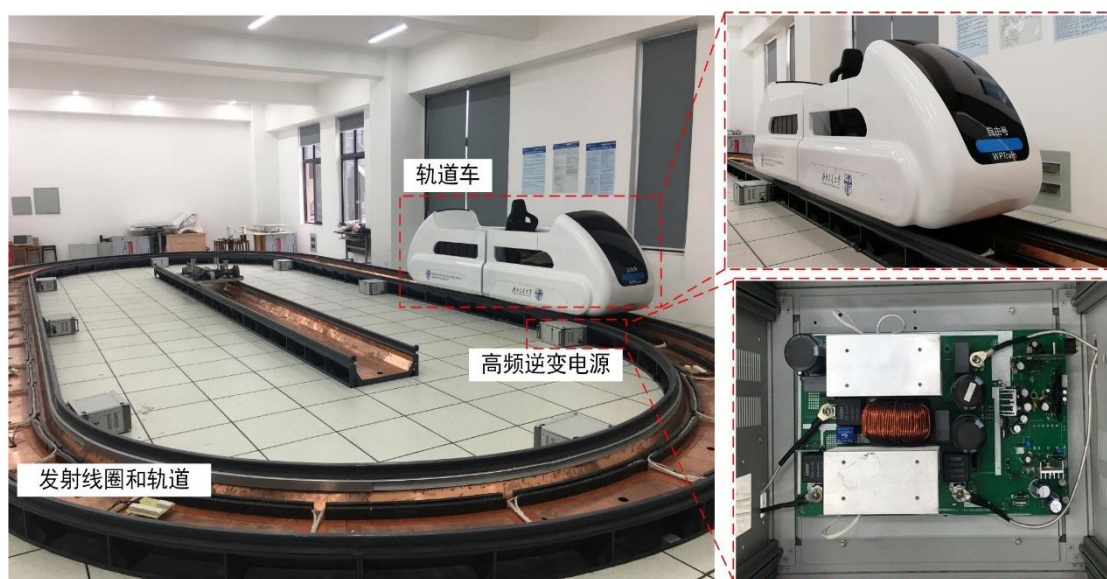
20kW 非接触牵引供电有轨电车平台
