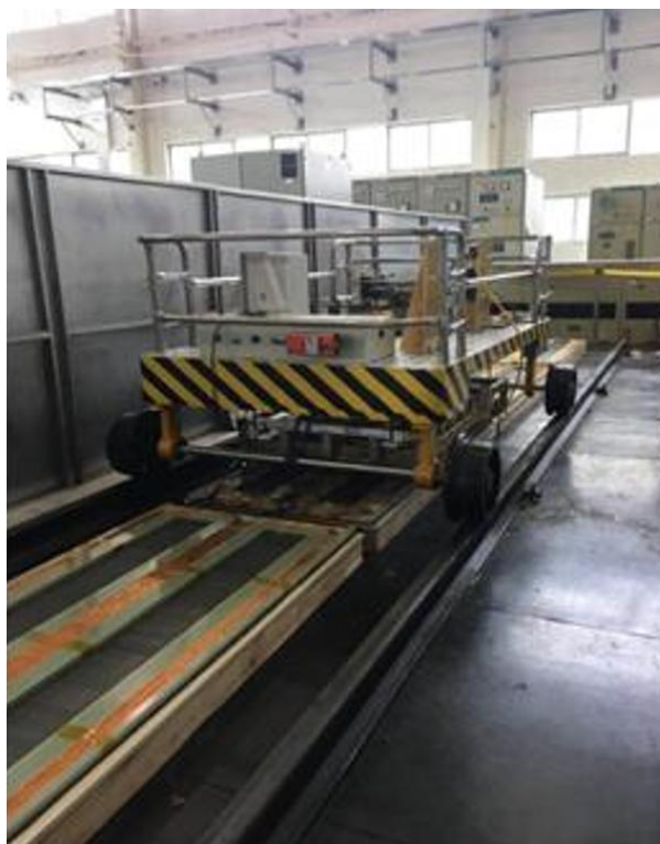
(a) 200kW 非接触牵引供电轨道小车
